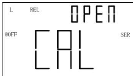
Рисунок 9 Калибровка в состоянии холостого хода (XX)
