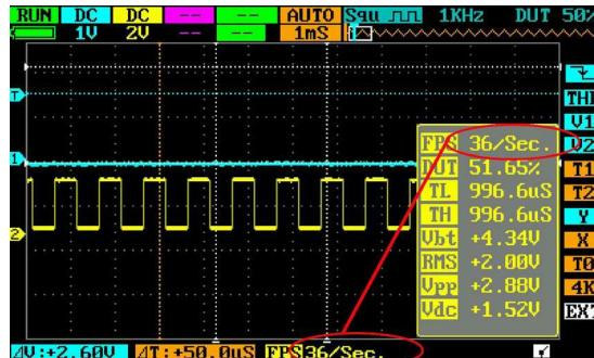
Кortко нажмите кнопку «Измерители» появится окно с 8-ю программируемыми измерителями, каждый из измерителей имеет 12 настроек, одновременно может быть отображено 8 параметров, кроме этого верхний измеритель дублируется в области
