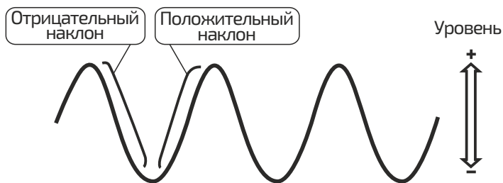
Рисунок 6. Иллюстрация полярности (фронтов) запуска синхронизации.
