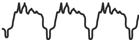
Рисунок 5. Осциллограмма строк ТВ-сигнала.
