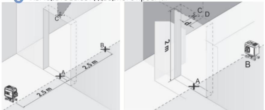
Повторите вышеописанную процедуру для второй вертикальной плоскости. Максимально допустимое отклонение высчитывается по формуле: высота проёма  $\times 2 \times 0,2 \text{ мм}/\text{м}$ .
