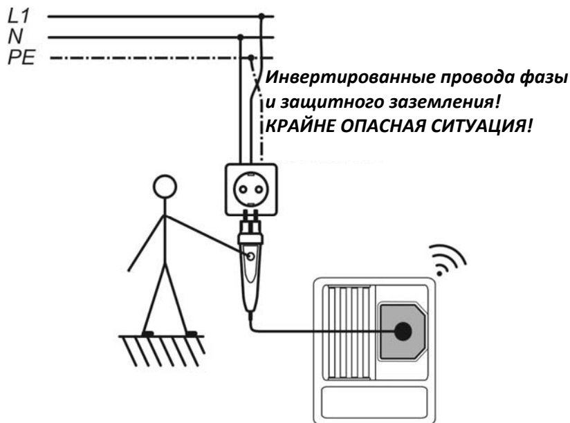
Рисунок 5.69: Инвертированные провода фазы и защитного заземления (L и PE) (шуп типа коммандер с вилкой (plug commander))
