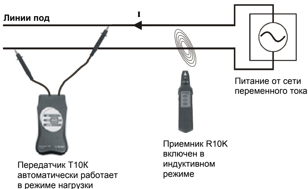
Рис. 3 Передатчик работает как активная нагрузка
