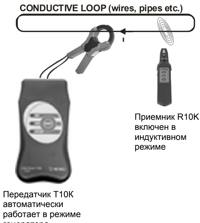
Рис.8 Подача испытательного тока на замкнутый тестируемый контур с помощью токовых клещей
