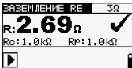
Рисунок 5.4: Пример результата измерения сопротивления заземления
