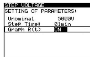
**Рис. 26.** Меню установок при режиме пошагового изменения сопротивления
