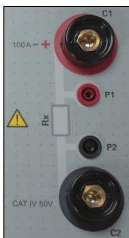
Рисунок 4.2: Клеммы тока и напряжения прибора MicroOhm 100A
