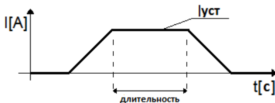
Рисунок 4.9: Трапецевидная форма тока
