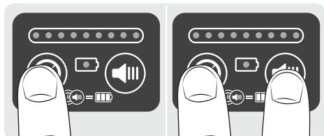
3. Индикация заряда батареи будет отображаться с помощью светодиодов в течение приблизительно трех секунд.
