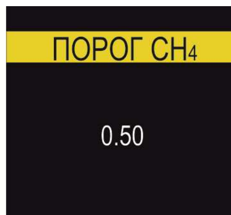
Рисунок 15 – Дисплей в режиме настройки Порог 2
