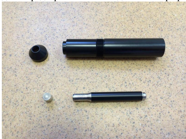
Рис.3в. Исходное состояние со снятым микрофоном
