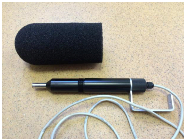
Рис.3е. Заключительный этап сборки: оденьте ветрозащиту на микрофон
