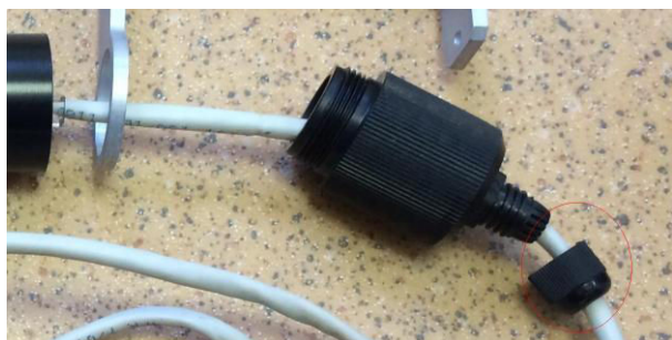
Рис.3ж. Ослабленный кабельный зажим гермоввода
