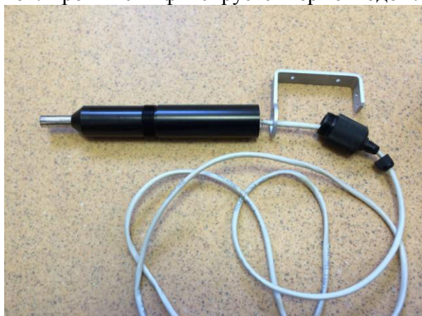
Рис.3д. Устройство с открученным гермовводом
