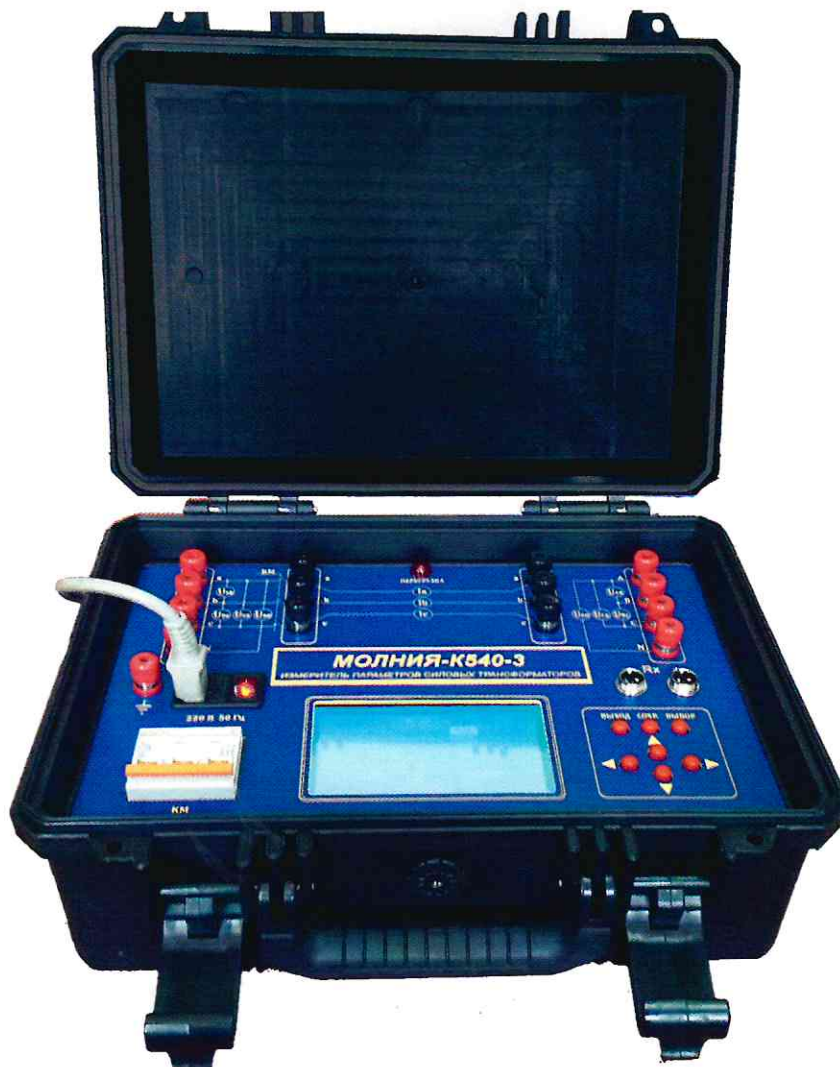
Рисунок 1 – Общий вид измерителей параметров силовых трансформаторов МОЛНИЯ-К540-3
