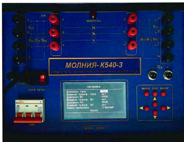
Рисунок 2 – Вид лицевой панели измерителей параметров силовых трансформаторов МОЛНИЯ-К540-3
