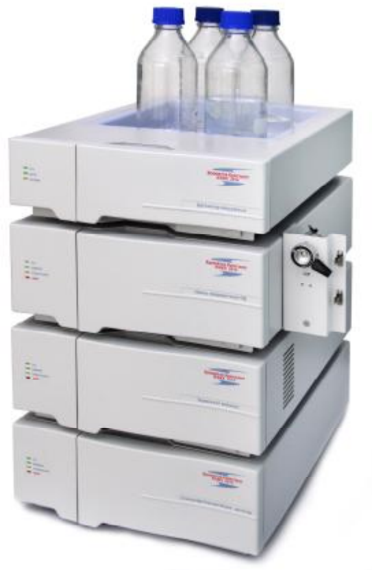
Рисунок 1 - Внешний вид одного из вариантов комплектации хроматографа
