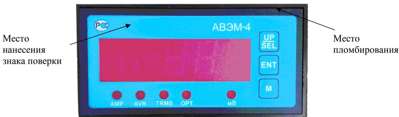
Рисунок 1 - Общий вид передней панели приборов измерительных АВЭМ-4 и схема пломбировки от несанкционированного доступа
