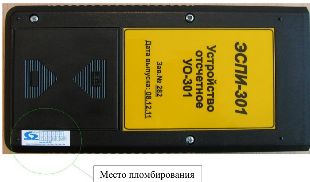
Рисунок 2 — Схема пломбирования измерителей напряженности электростатического поля ЭСПИ-301 от несанкционированного доступа
