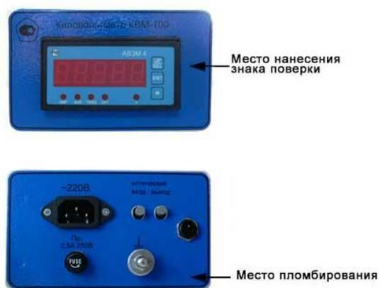
Рисунок 2 – Схема пломбировки
