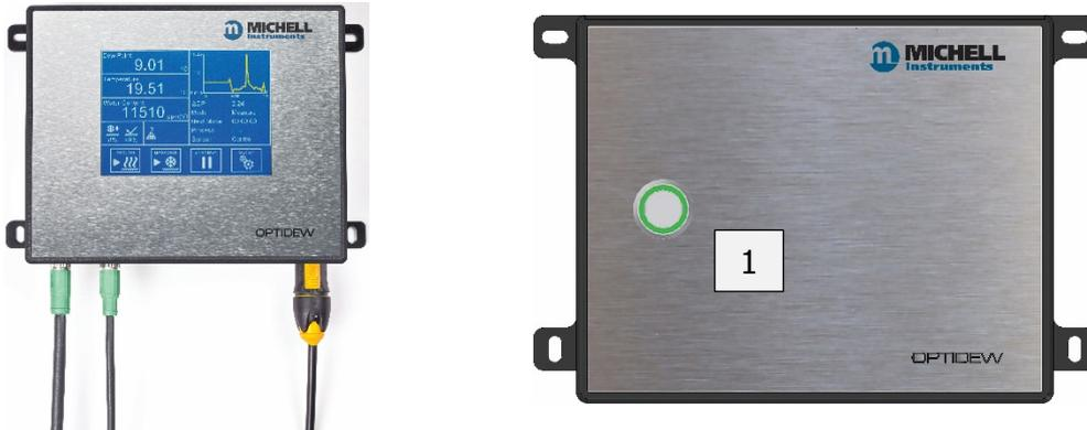
Рис 6 Optidew 501 с сенсорным экраном или кнопкой динамического контроля загрязнения (DCC)
