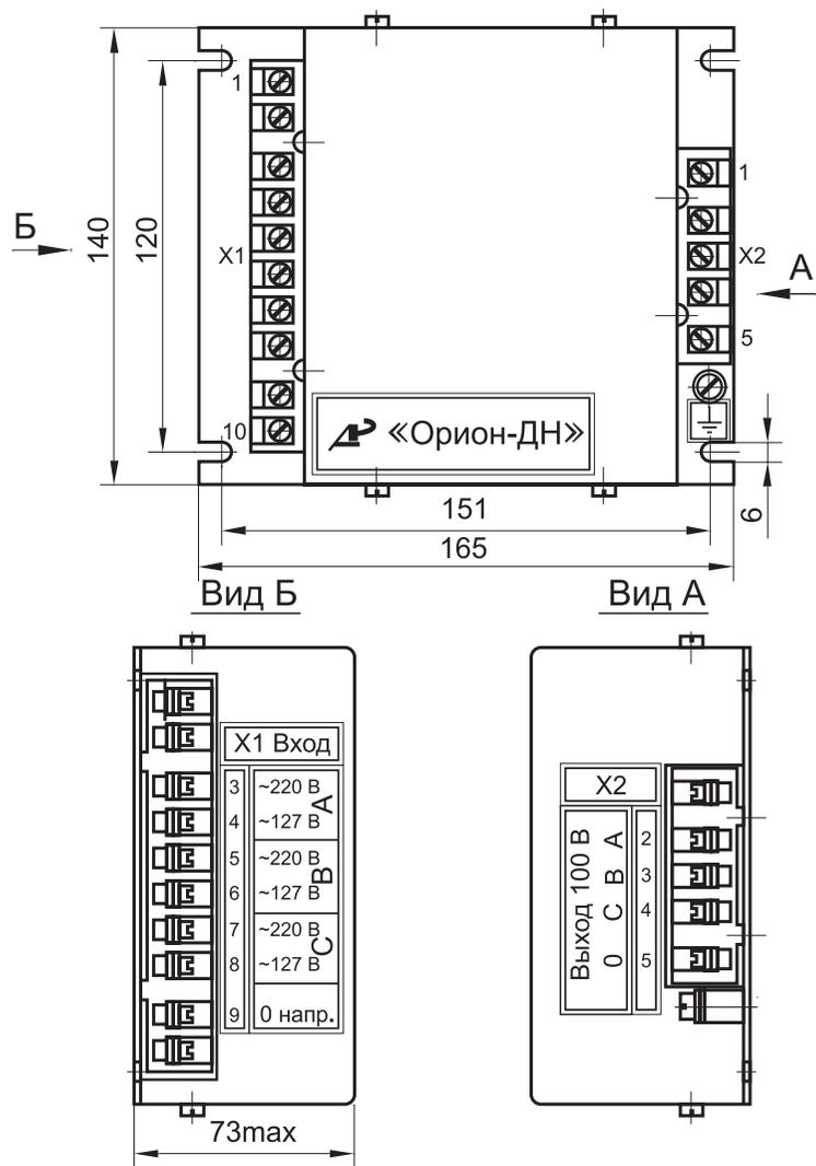
Рис. 1 Внешний вид, габаритные и присоединительные размеры делителя напряжения
