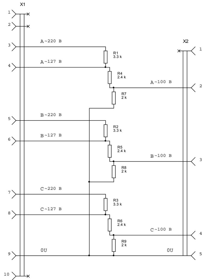
Рис. 2 Схема электрическая принципиальная делителя напряжения
