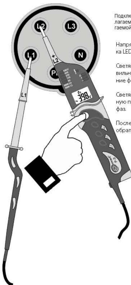
Подключить зонд L1 измерителя к предполагаемой фазе L1, а зонд L2 — к предполагаемой фазе L2. Прикоснуться к электроду.
