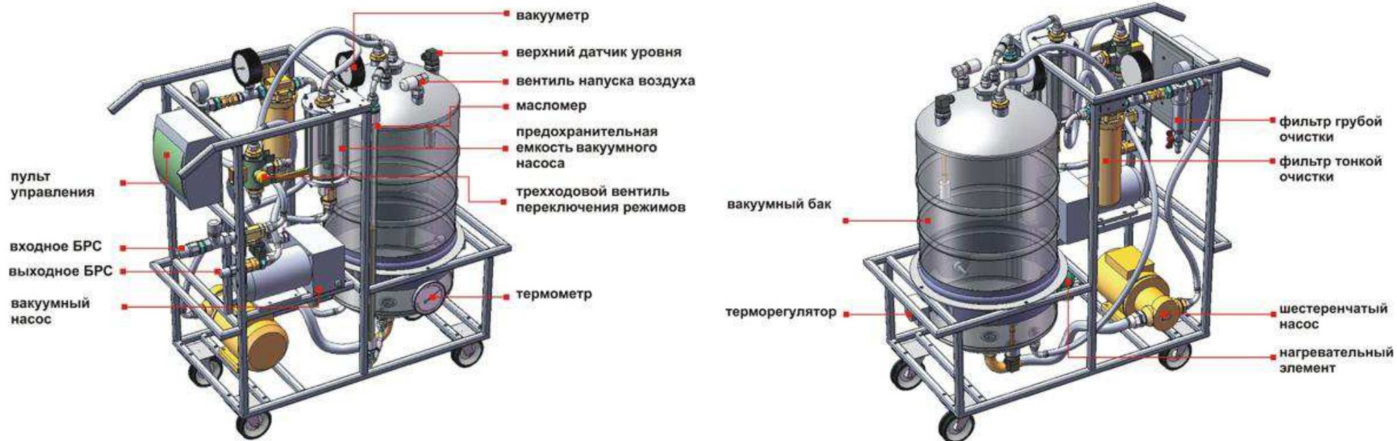
Рис.1 Внешний вид, состав установки УФ-250
