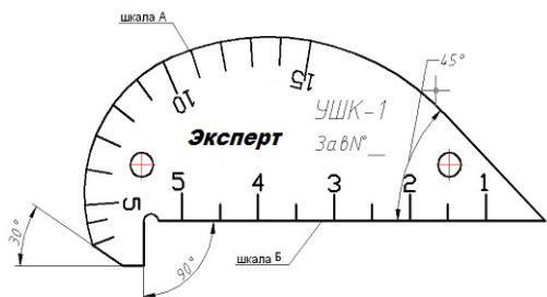
Шкала А предназначена для контроля тавровых и нахлесточных сварных соединений и измерения зазора между кромками. Цена деления шкалы А - 1мм. Отклонение положений штрихов от действительных значений - не более  $\pm 0,5$ мм.
