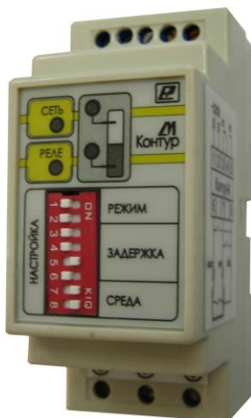
Рисунок 1 – Контроллер уровня «Контур–М»
