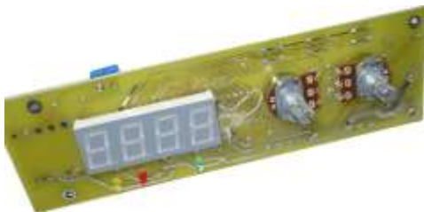
Передняя сторона панели терморегулятора РАТАР-02-1-б/к
