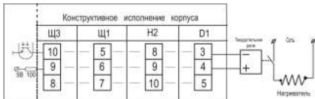
Схема подключения терморегулятора РАТАР-02М.ТС с транзисторным выходом
