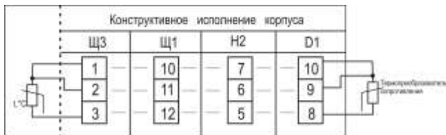
Схема подключения датчика температуры к терморегулятору PATAP-02M.TC
