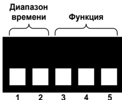
**Рисунок 2 – Расположение переключателей реле времени РВ-01М**
