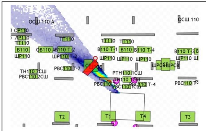
Поиск и локация дефектного оборудования на подстанции при помощи системы мониторинга PD-Мар производится по результатам контроля разницы времени прихода в прибор высокочастотных
