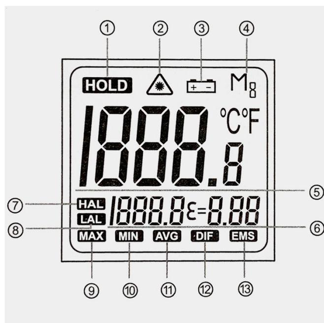
1. Сохранение измеренного значения температуры. Нажмите на спусковой крючок и наведите пирометр на объект. После измерения отпустите крючок, и измеренное значение зафиксируется на экране.
