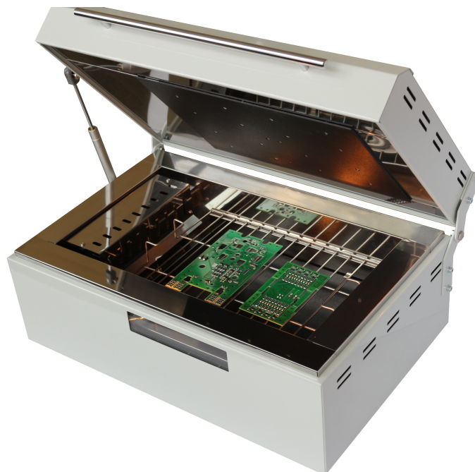
Фото 4. Размещение плат в нагревательной камере
