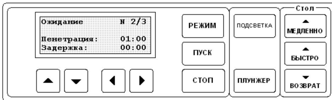
Рисунок 2 – Лицевая панель пенетрометра
