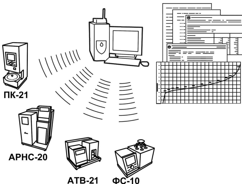
Для работы системы необходимо приобрести и установить радиомодем с USB интерфейсом и программное обеспечение для персонального компьютера. Программное обеспечение включает в себя драйвер радиомодема и программу -ЛИНК.
