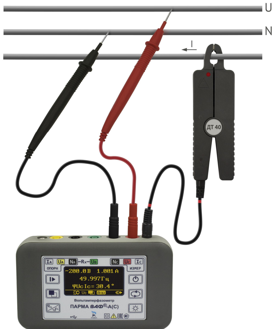
Рисунок 14 Схема подключения для измерения мощности
