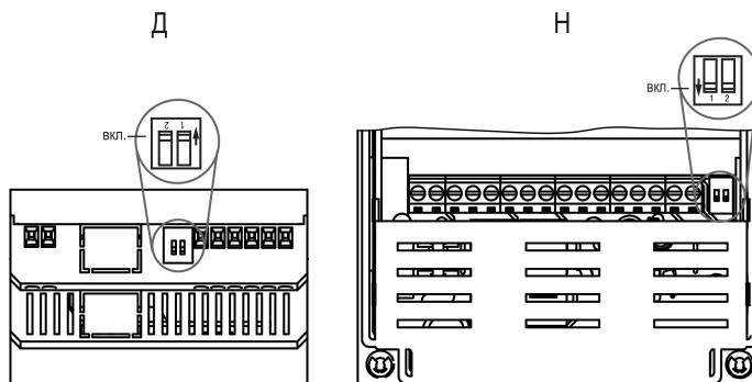
**Рисунок 5.14 – Расположение DIP-переключателей для корпусов Д и Н**
