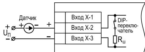
**Рисунок 5.12 – Схема подключения пассивного датчика с токовым выходом  $0\ldots5$  мА или  $0$  ( $4\ldots20$ ) мА**
