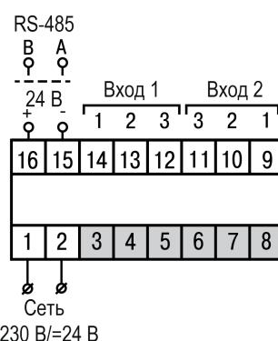
Рисунок 5.4 – Общая схема подключения 2TPM0-Щ5
