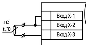
**Рисунок 5.9 – Двухпроводная схема подключения ТС**
