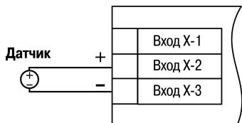
**Рисунок 5.11 – Схема подключения активного датчика с выходом в виде напряжения  $-50\ldots+50$  мВ или  $0\ldots1$  В**
