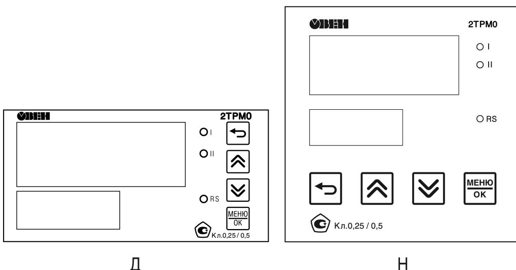
Рисунок 6.3 – Лицевая панель корпусов Д и Н
