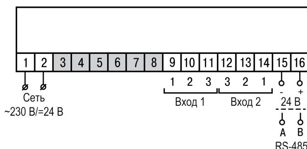
Рисунок 5.3 – Общая схема подключения 2TPM0-Щ1/Щ2
