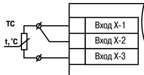
**Рисунок 5.8 – Трехпроводная схема подключения ТС**
