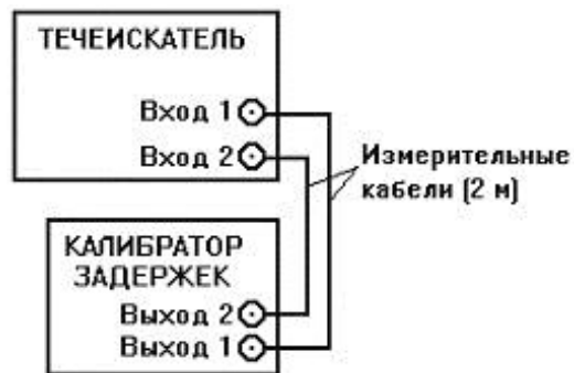
Рис.26. Схема для тестирования рабочих станций с помощью калибратора задержек
