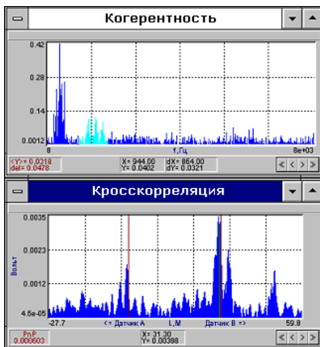
Рис.56. Определение места первой утечки на отводе к гидранту ж/дома № 331.
