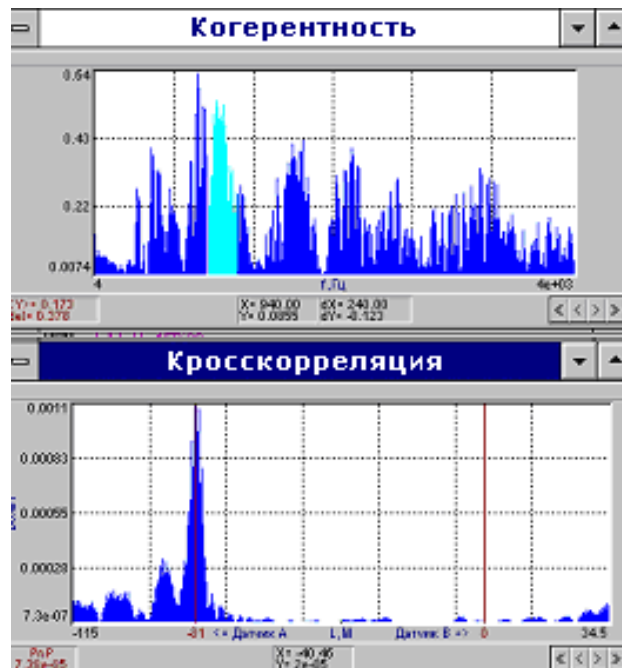
Рис.34. Функции когерентности и взаимной корреляции и окно "Поиск утечек" на экране прибора при тестировании трубопровода.
