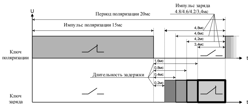
Рис. 4.3 Временные диаграммы управления ключами заряда и поляризации
