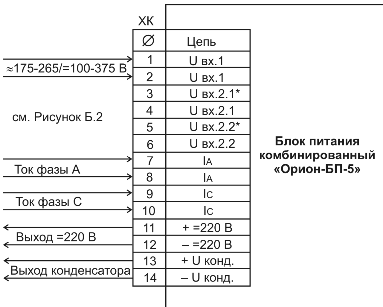
Рисунок Б.1 – Схема расположения клемм разъема ХК
