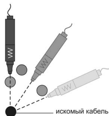
Рисунок 5.4.2 – Отбор жилы по минимуму сигнала
