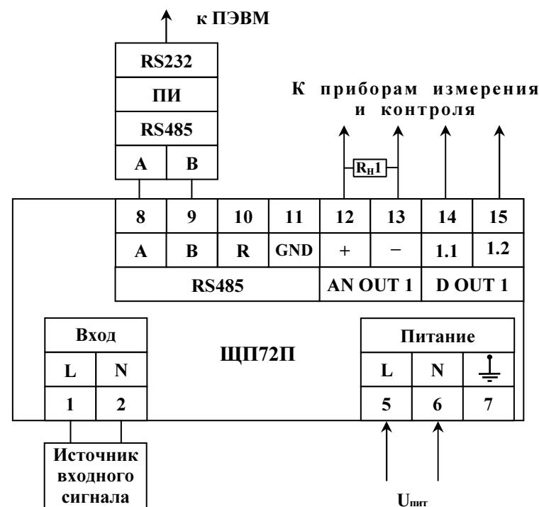
$U_{пит}$  – напряжение питания от 85 до 253 В переменного тока частотой 50 Гц или от 120 до 265 В постоянного тока (220ВУ), напряжение питания от 85 до 253 В переменного тока частотой 50 Гц (230В).
