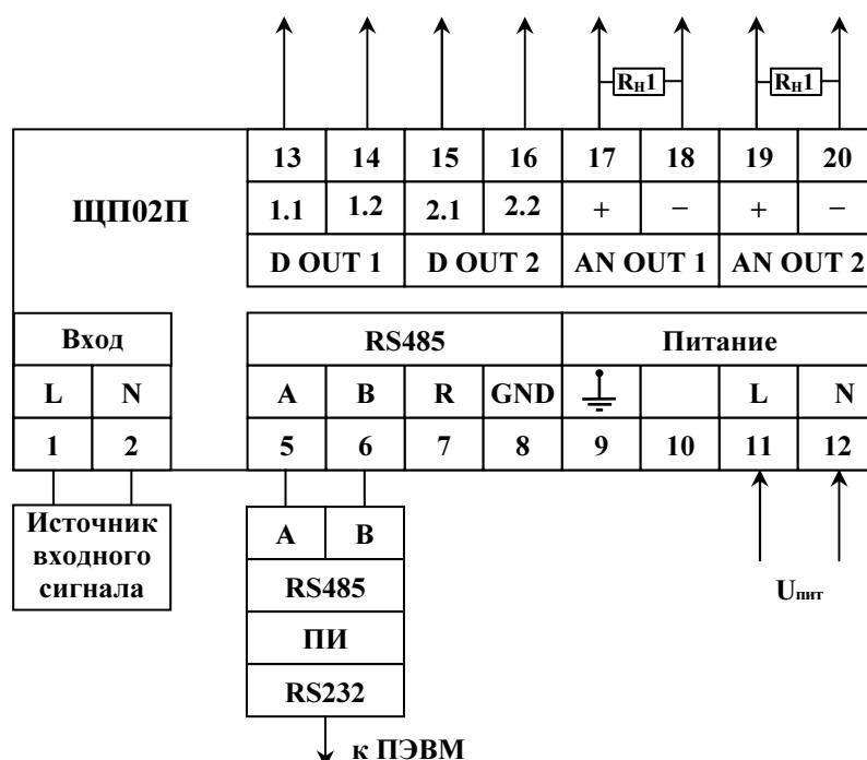
$U_{пит}$  – напряжение питания от 85 до 253 В переменного тока частотой 50 Гц или от 120 до 265 В постоянного тока (220ВУ), напряжение питания от 85 до 253 В переменного тока частотой 50 Гц (230В).
