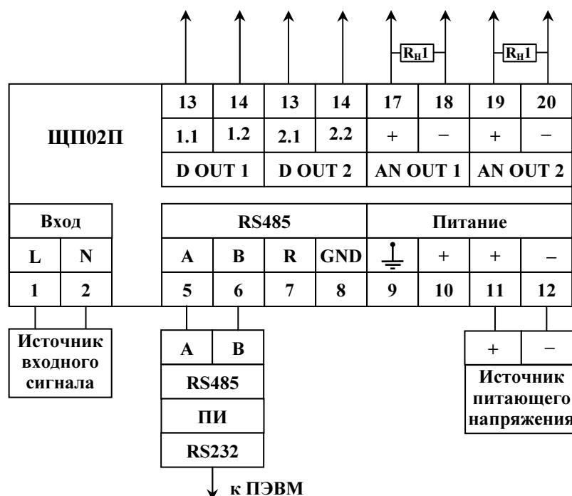
а) для исполнений с параметром  $c = 5\text{ВН}, 12\text{ВН}, 24\text{ВН}$
