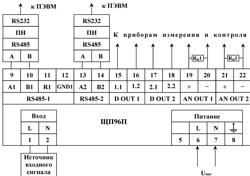
$U_{пит}$  – напряжение питания от 85 до 253 В переменного тока частотой 50 Гц или от 120 до 265 В постоянного тока (220ВУ), напряжение питания от 85 до 253 В переменного тока частотой 50 Гц (230В).
