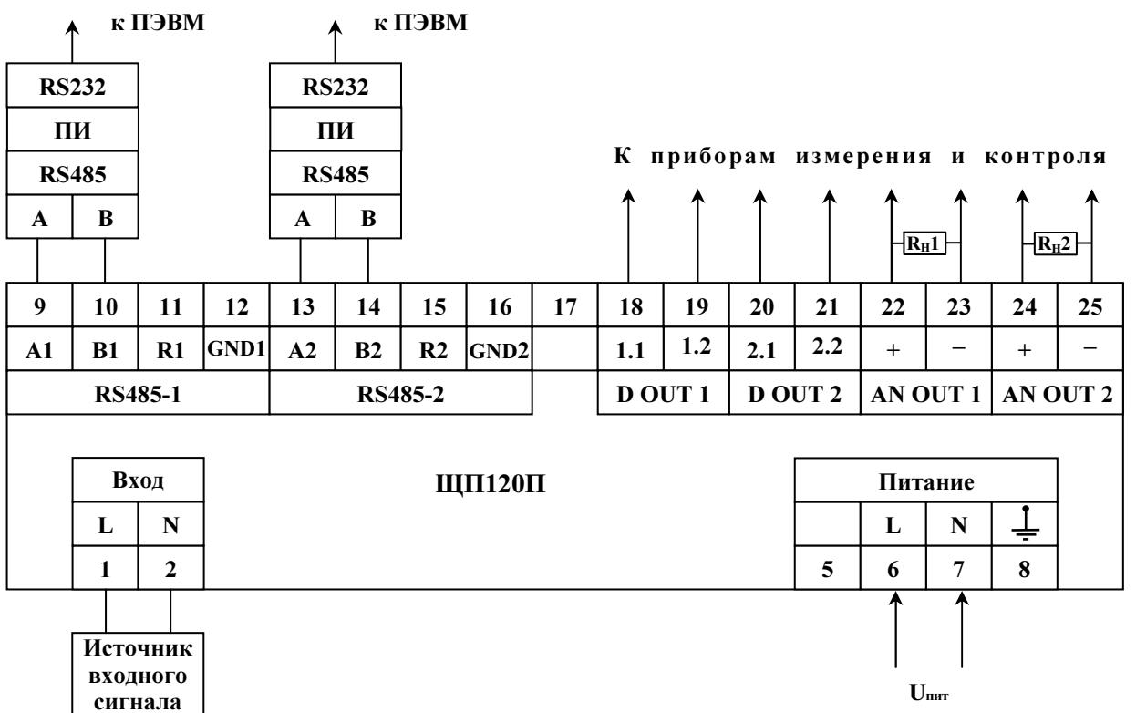
$U_{пит}$  – напряжение питания от 85 до 253 В переменного тока частотой 50 Гц или от 120 до 265 В постоянного тока (220ВУ), напряжение питания от 85 до 253 В переменного тока частотой 50 Гц (230В).
