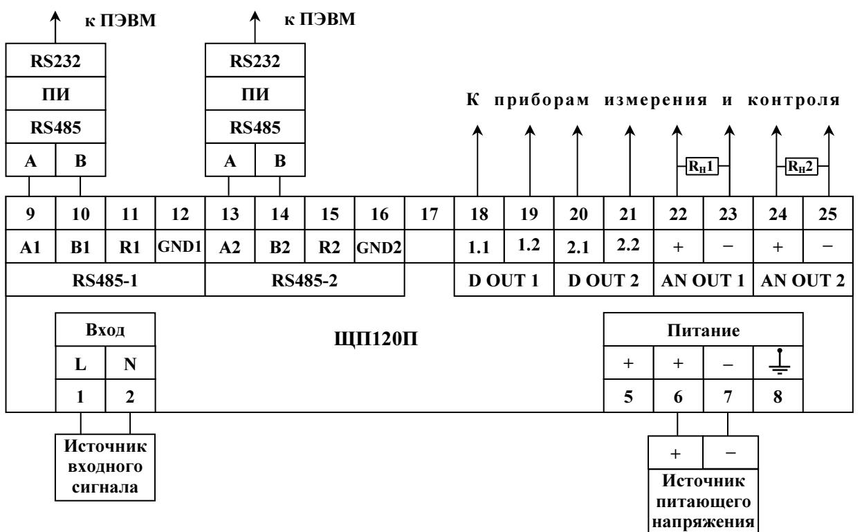
а) для исполнений с параметром  $c = 5\text{ВН}, 12\text{ВН}, 24\text{ВН}$
