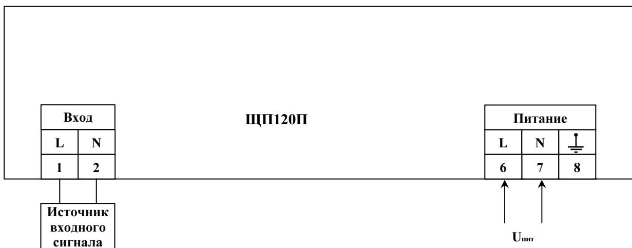
$U_{пит}$  – напряжение питания от 85 до 253 В переменного тока частотой 50 Гц или от 120 до 265 В постоянного тока (220ВУ), напряжение питания от 85 до 253 В переменного тока частотой 50 Гц (230В).
