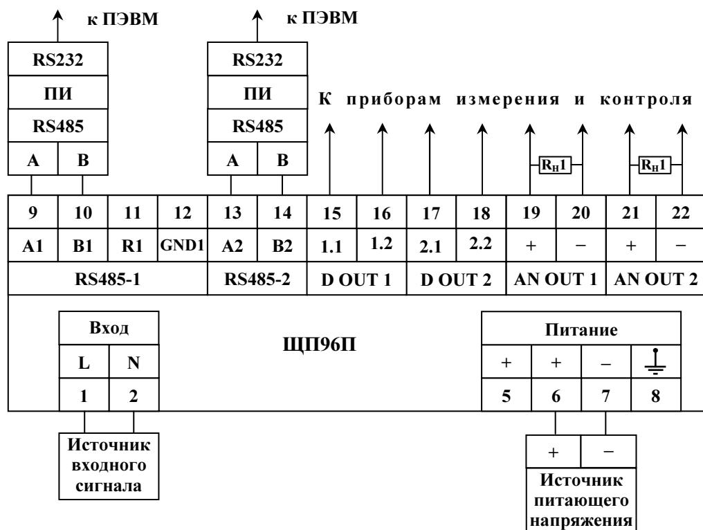
а) для исполнений с параметром  $c = 5\text{ВН}, 12\text{ВН}, 24\text{ВН}$
