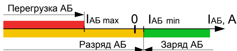
Рисунок 1.1 – Границы срабатывания функции контроля тока АБ
