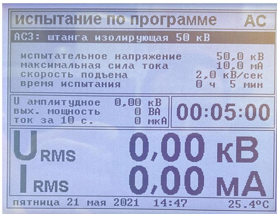
Рис. 7. Экран аппарата в режиме испытания по программе.
