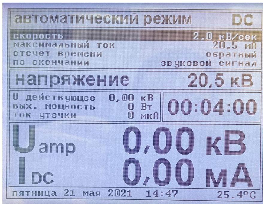
Рис. 6. Экран аппарата в автоматическом режиме.
