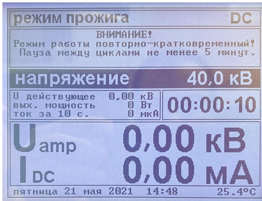
Рис. 8. Экран аппарата в режиме прожига.
