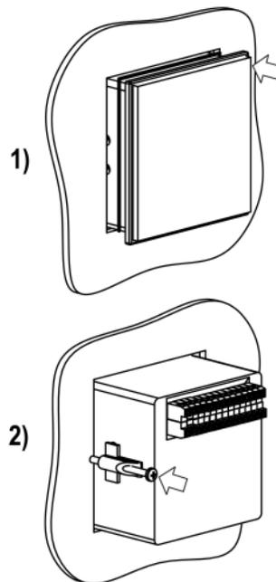
**Рисунок 4.5 – Монтаж прибора щитового крепления**
