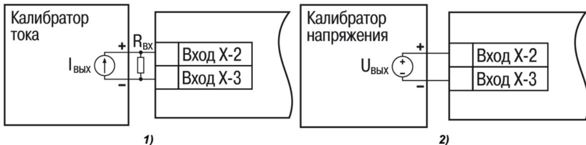
**Рисунок 8.6 – Подключение калибратора: 1) постоянного тока, 2) постоянного напряжения**
