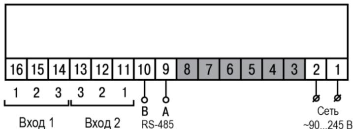
Рисунок 5.3 – Общая схема подключения TRM200-Н2
