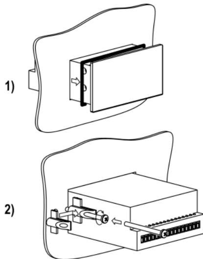
**Рисунок 4.8 – Монтаж прибора щитового крепления**
