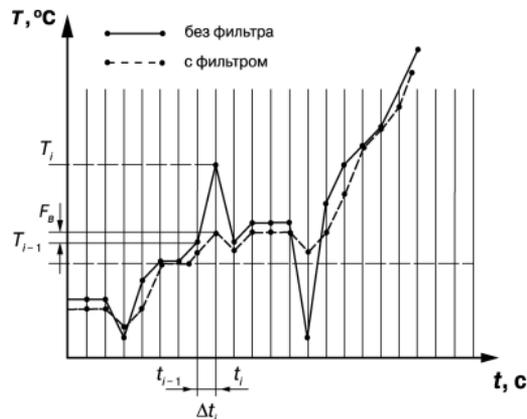
Рисунок 7.4 – Параметры цифрового фильтра
