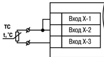
Рисунок 5.6 – Двухпроводная схема подключения ТС
