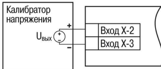
Рисунок 8.4 – Подключение при юстировке ТП
