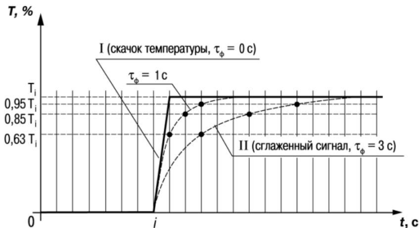
**Рисунок 7.5 – Работа цифрового фильтра**
