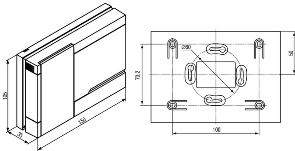
**Рисунок 4.4 – Габаритные размеры корпуса H2**
