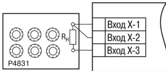
Рисунок 8.3 – Подключение при юстировке ТС
