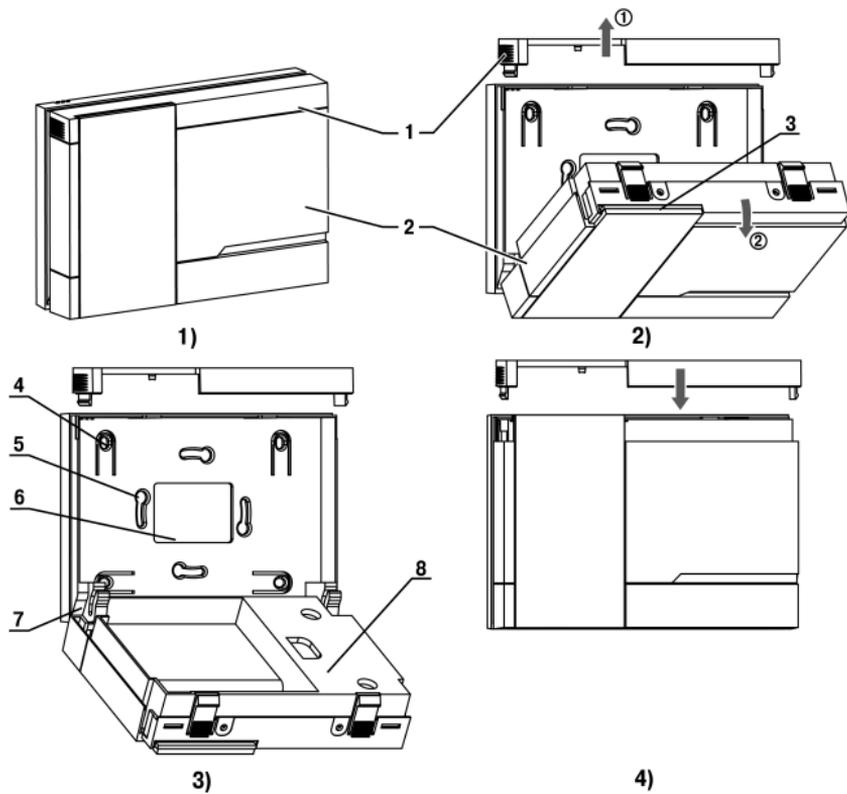
**Рисунок 4.3 – Монтаж прибора настенного исполнения H2**
