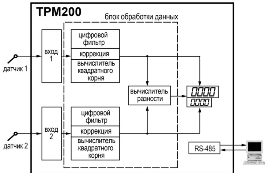
**Рисунок 6.1 – Функциональная схема прибора**
