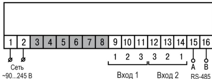
Рисунок 5.2 – Общая схема подключения TRM200-Н, -Щ1 и -Щ2
