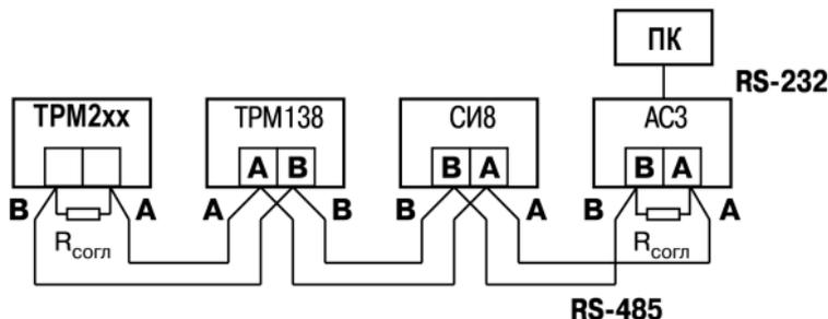
**Рисунок 5.4 – Подключение приборов по сети RS-485**
