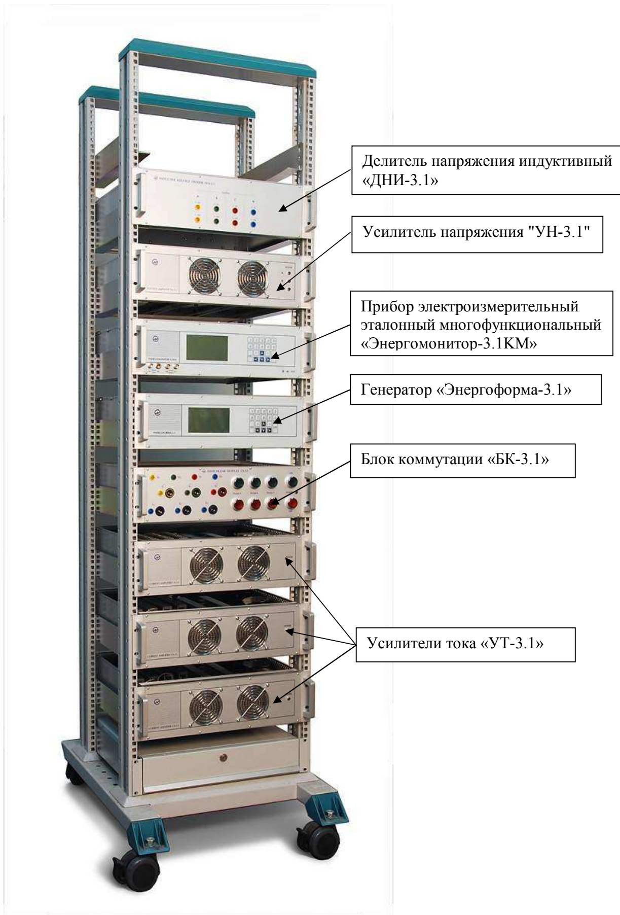
Рисунок 2.1. Стойка с установленными в ней ИИС и эталонным СИ
