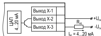
Рисунок 5.21 – Подключение к ВУ типа «И»
