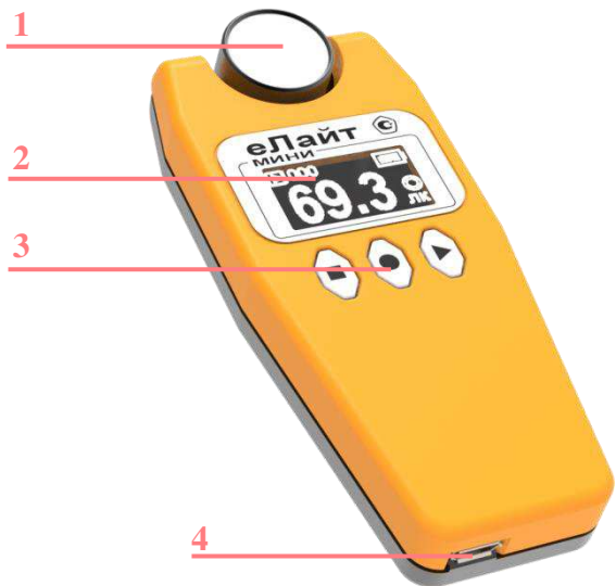
Рис.1.4.1. Внешний вид люксметра «еЛайт-мини» (лицевая сторона).
