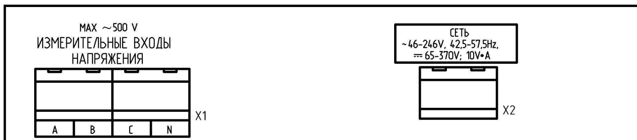
Рисунок Б.8 – Расположение элементов измерительного клеммного отсека приборов «Ресурс-ПКЭ-1.Х-оэ-Х»
