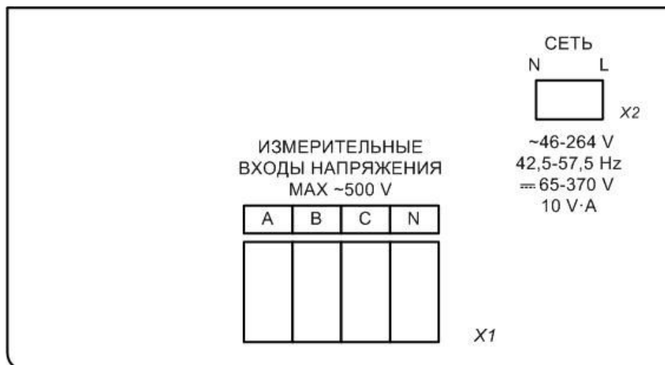
Рисунок Б.4 – Расположение элементов измерительного клеммного отсека приборов «Ресурс-ПКЭ-1.Х-вэ-Х»
