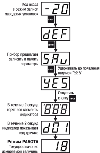
Рисунок 7.17 – Схема восстановления заводских установок
