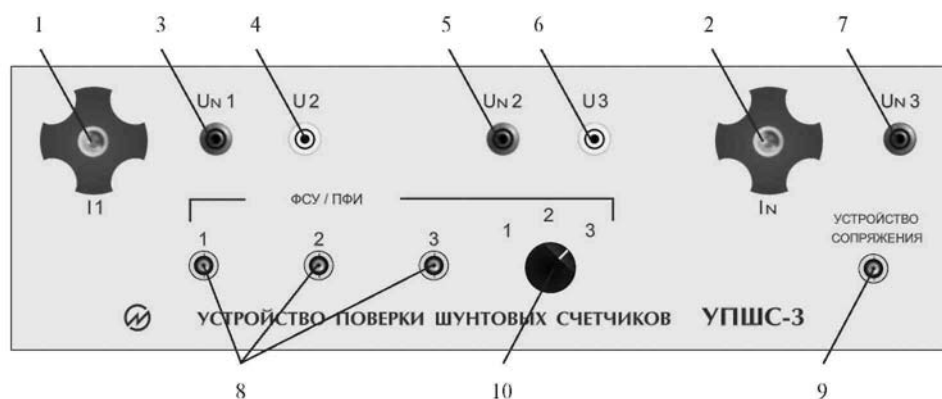
Рис. 2.1. Передняя панель УПШС-3:
