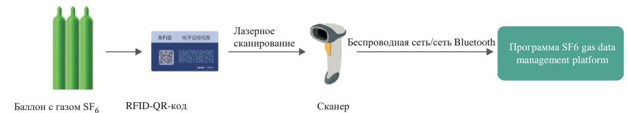
Схема управления данными QR-кода газовых баллонов
