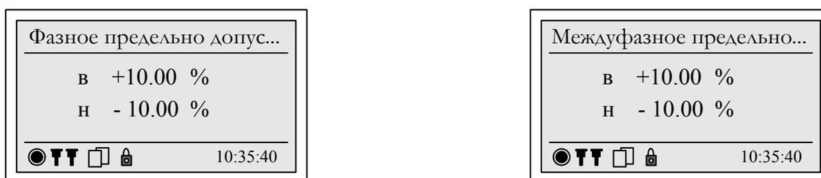
Рисунок 7.50 – Отображение предельно допустимых значений отклонений фазного и междуфазного напряжения
