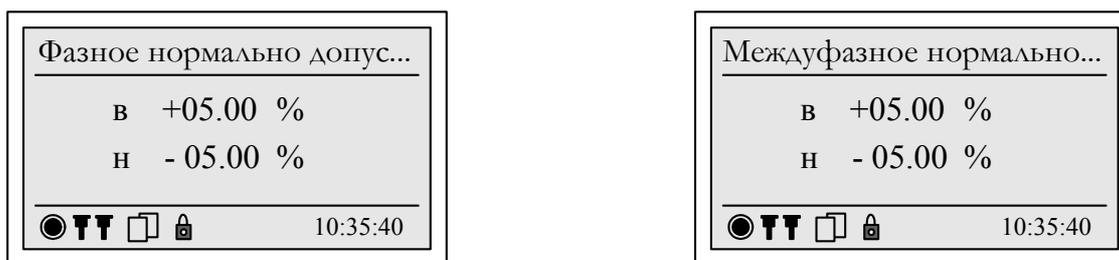
Рисунок 7.49 – Отображение нормально допустимых значений отклонений фазного и междуфазного напряжения
