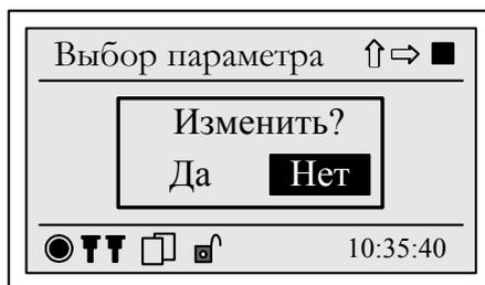
Рисунок 7.30 – Запрос на отображение параметра
