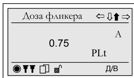
Рисунок 7.10 – Пример вывода результатов измерений длительной дозы фликера
