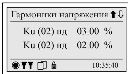
Рисунок 7.56 – Отображение допустимых значений коэффициентов гармоник
