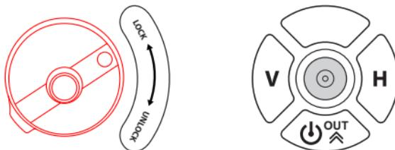
Клавиша H управляет включением/отключением горизонтальной линии. Клавиша V отвечает за включение/выключение вертикальной линии, повторное нажатие включает вторую (у LP-62), третью и четвертую (у LP-64) вертикали. Лазерный отвес включается при нажатии кнопки V. Переключение тумблера в позицию LOCK блокирует компенсатор и позволяет работать с наклонными плоскостями.
