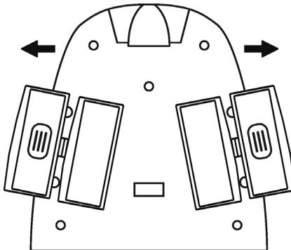
3. Подключите источник питания к разъему аккумулятора, соблюдая полярность. Затем поместите аккумулятор в отсек.
